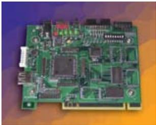
产品: 基于32位CPU的多用途高性能安全芯片HT32A256
